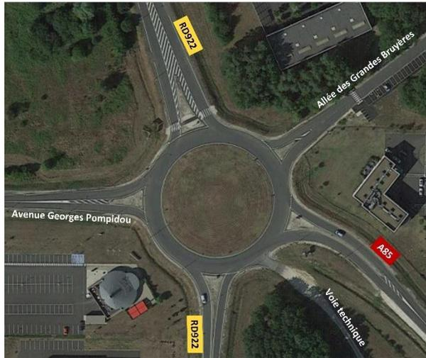
Ce carrefour giratoire dispose également de très bonnes réserves de capacité, ce qui permet d'écouler les flux sans créer de remontée de file.
